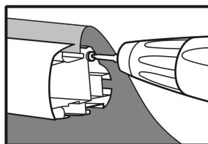
**3** - Wir entfernen die Schrauben, die das Tuch und den Volant befestigen.
