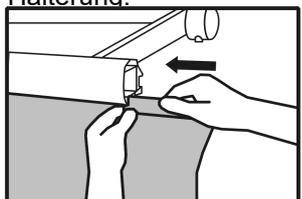
**9** - Wir setzen den Volant in die untere Nut des Lastprofils ein.
