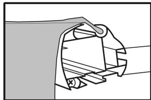
**11** - Wir führen den Markisenstoff durch die obere Nut des Lastprofils ein.
