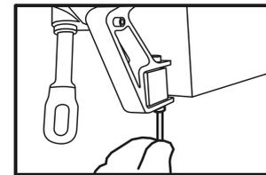
**16** - Wir befestigen die Schraube der Motor- oder Kurbelhalterung.
