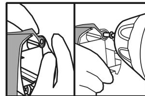
**12** - Wir setzen einen Dübel erneut ein und befestigen ihn mit einer Schraube.
