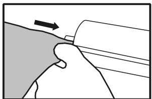
**13** - Wir führen den oberen Teil des Markisenstoffs in die Nut der Wickelstange ein.
