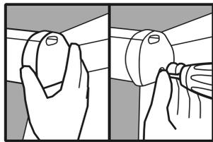
**18** - Abschließend setzen wir die seitlichen Abdeckungen des Lastprofils wieder ein und befestigen sie mit einer Schraube.
