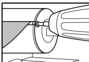
**6** - Wir entfernen die Schrauben an der Wickelstange, mit denen der Stoff befestigt ist.
