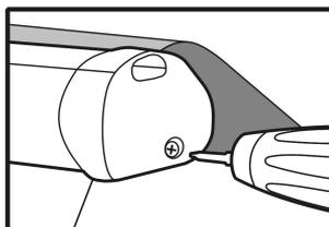
**2** - Wir entfernen die Schrauben, die die seitlichen Abdeckungen des Lastprofils befestigen, um sie abzunehmen.
