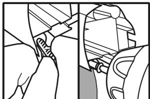
**10** - Wir setzen einen Dübel ein und befestigen ihn mit einer Schraube.
