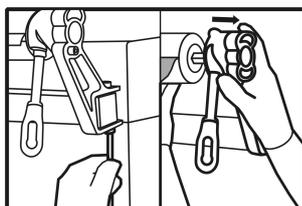
**5** - Wir lösen die Schraube der Motor- oder Kurbelhalterung und entfernen die gesamte Halterung.
