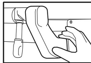
**4** - Wir entfernen die seitlichen Abdeckungen der Motor- oder Kurbelhalterung sowie des Endstücks.
