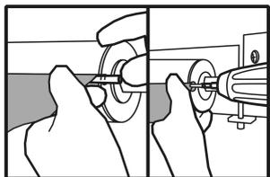
**14** - Auch hier setzen wir einen Dübel ein und befestigen ihn mit einer Schraube.
