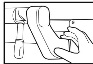
**4** - Nous retirons les flasques latérales du support moteur ou manivelle et de l'extrémité.
