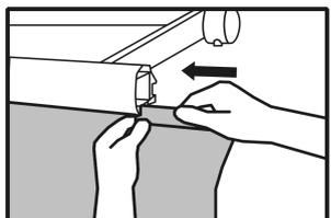
**9** - Nous insérons le lambrequin dans la rainure inférieure du profil de charge.
