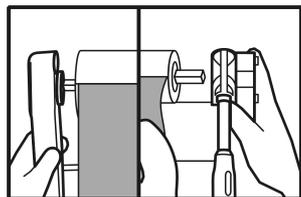
**15** - Nous repositionnons les flasques latérales du support moteur ou manivelle et de l'extrémité.
