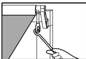
**1** - Avec l'aide de la manivelle, nous déployons la toile jusqu'à ce que la barre d'enroulement soit visible.
