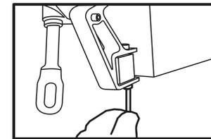
**16** - Nous fixons la vis du support moteur ou manivelle.
