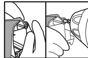
**12** - Nous réinsérons une cheville et fixons avec une vis.
